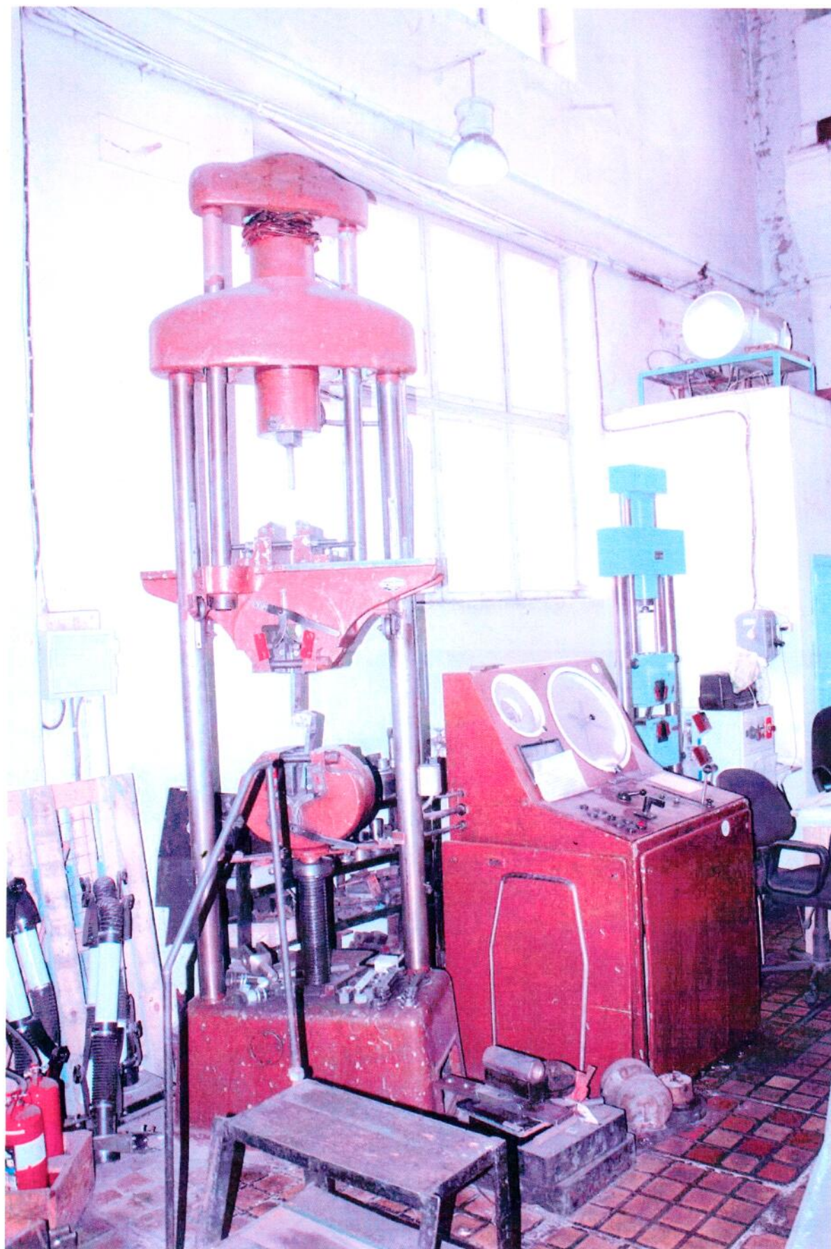
Рисунок 6 - Общий вид испытательной машины МУП-50, №166. Свидетельство о госповерке № С-МА/08-08-2022/178821586.
