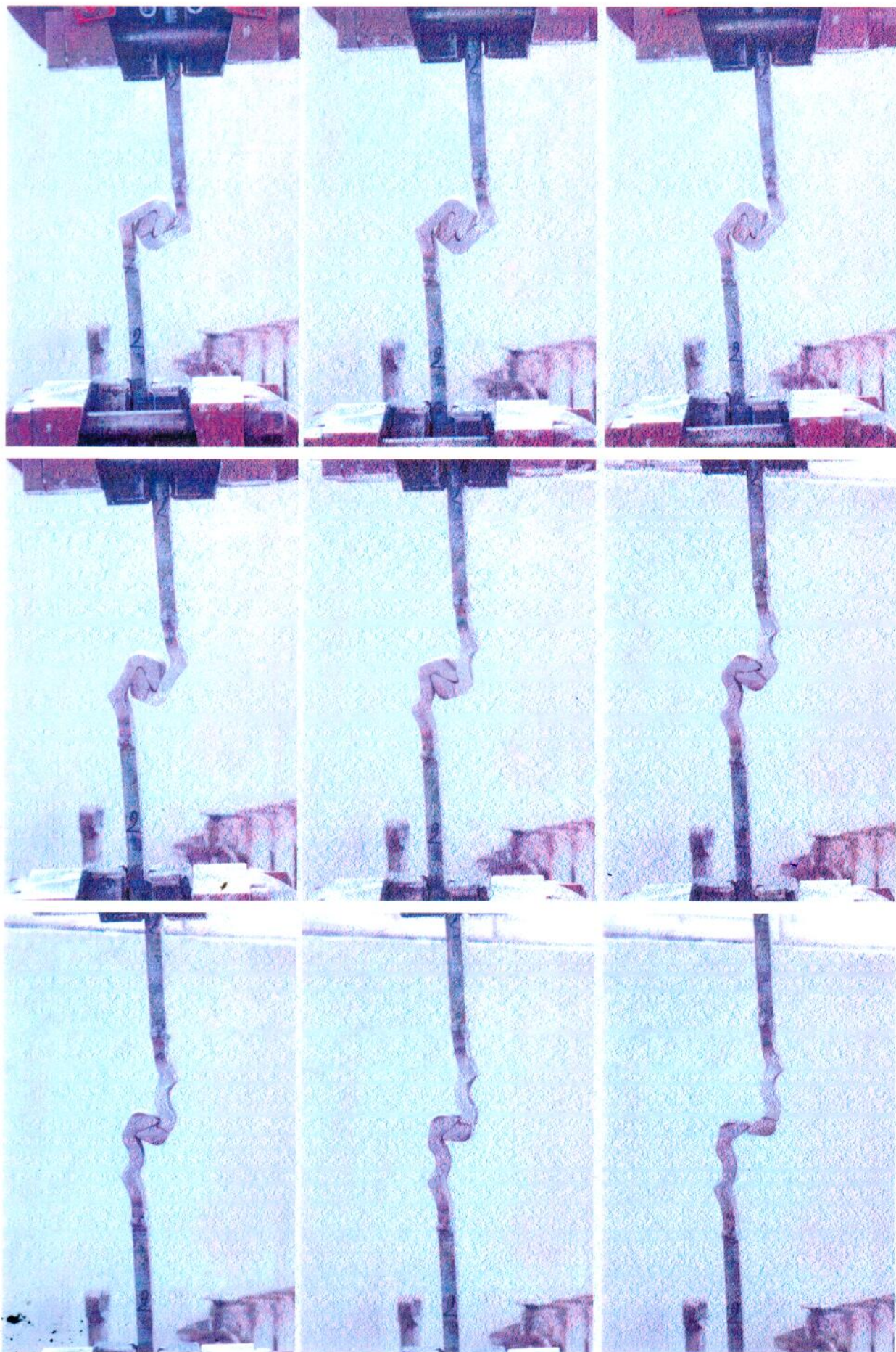
Рисунок 12 - Кинетика изменения замкового соединения сварного шпунтового профиля производства ООО «ВетроСтройДеталь» (образец №2).
