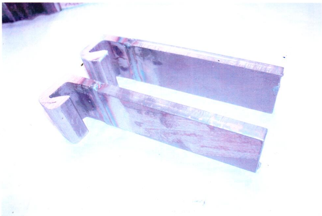
Рисунок 5 - Образец замкового соединения шпунтовой сваи типа «Ларсен» перед испытаниями.
