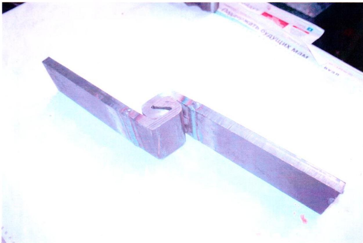
Рисунок 4 - Образец замкового соединения шпунтовой сваи типа «Ларсен» перед испытаниями.
